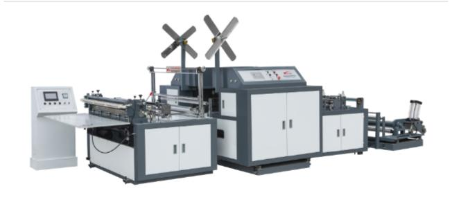
此款机器主要用于无纺布纸尿裤外包装袋的生产,袋子造型独特,将袋子插底后用滚轮超声波将底部压合,将把手烫于袋底,相比普通塑料袋,更美观,更环保。在原有制袋机的基础上,完美融入自动烫把的功能。真正脱离人工,实现无纺布手提袋的全自动制作,相比同类机器,烫把精度高,废料更少,速度更快。为您实现比较大化效益可以制作平口袋,手提袋,插底袋,背心袋,穿绳鞋袋,礼品袋,等多种不同规格的袋子,制作不同袋子只要改变穿料方式即可达到. 操作简单,效率及高,稳定性好。整机采用微机电脑控制. 步进电机拖料. 自动定位上把手,任意定长,步长光电跟踪,准确平稳。丢标自动停机,自动同步打孔,自动计数报警
